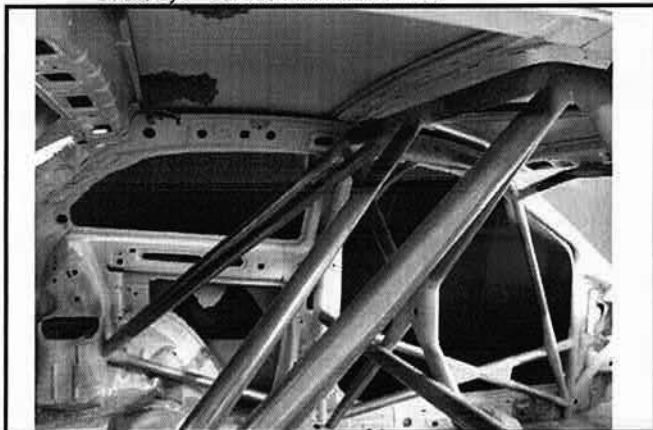
SC-29) Jambes de force arrière – Jonction avec arceau principal Backstays – Junction with main rollbar
